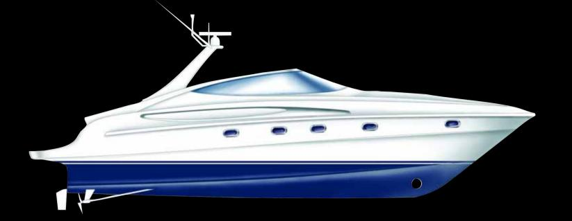
Materiale di costruzioneVetroresinaLunghezza f.t.m. 13,37Lunghezza (LH)m. 12,72Larghezza massimam. 3,88Immersionem. 1,08Dislocamento a seccot. 11,00Motorizzazione2 Diesel Volvo Penta IPS 400 da 228 kW (310 hp)<br/>2 Diesel Volvo Penta IPS 500 da 272 kW (370 hp)Capacità serbatoi carburantel. 1.200
