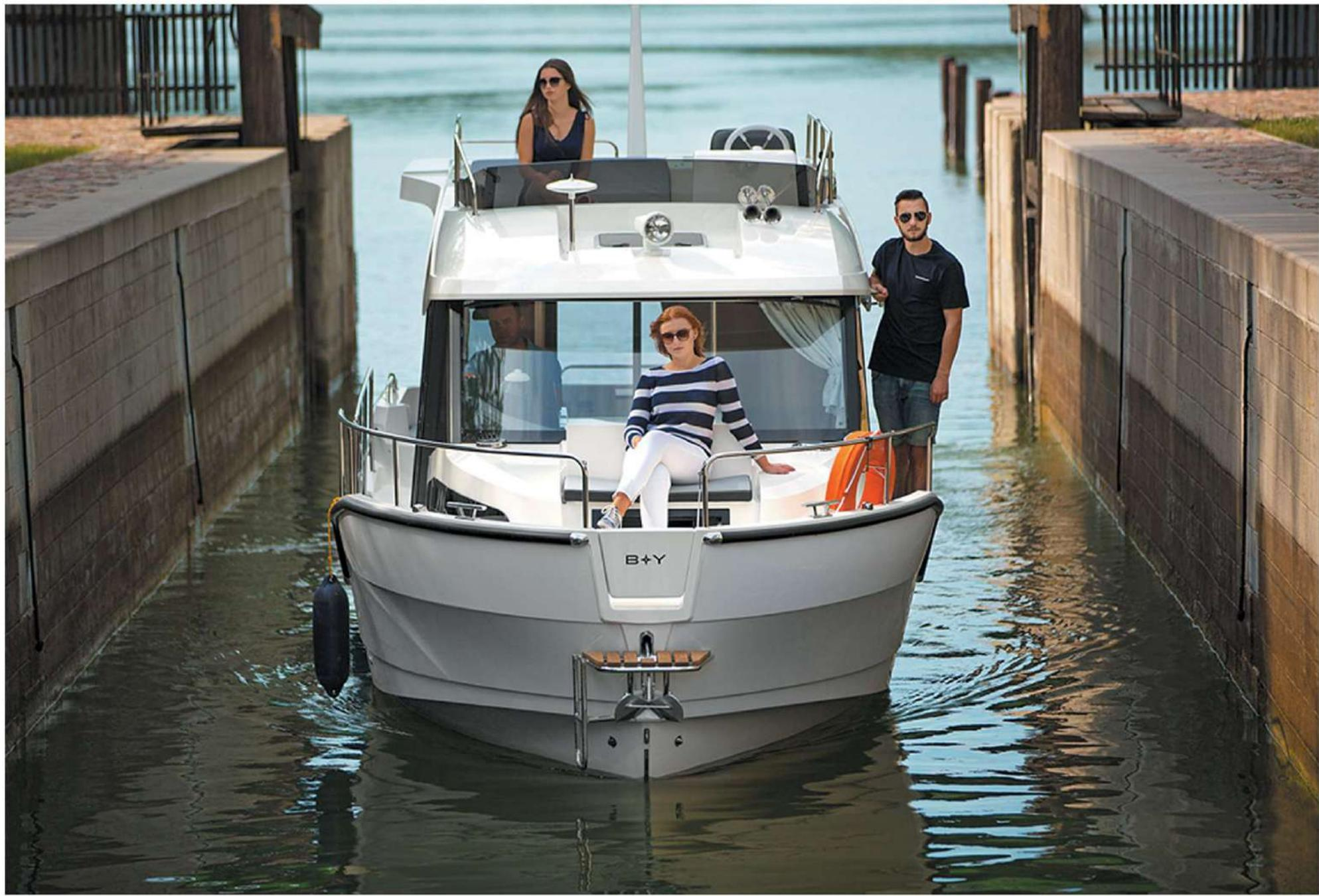
**ODKRYWANIE NIEDOSTĘPNYCH WÓD** Niemal wszystkie akweny staną się dostępne dzięki: malemu zanurzeniu, optymalnej szerokości łodzi - 3m (wąskie śluzy, przewężenia kanałów, wózki pochylni), ograniczonej wysokości nad linią wodną (3,5 m; 2,9 m po położeniu maszcziku sygnalowego czy zaledwie 2,55 m po zdemontowaniu relingu i owiewki na dachu oraz położeniu maszcziku [niskie mosty do pokonania!]).
