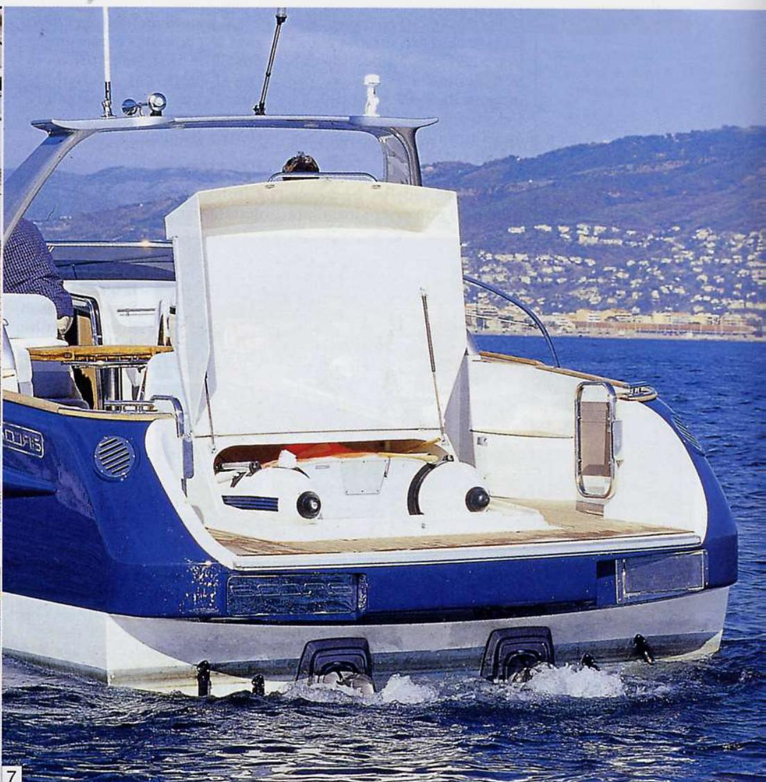
come l'alzatina perimetrale e la piastra di protezione dal calore, evidenziano l'attenzione del costruttore per la funzionalità e la sicurezza. Il rollbar, leggero nella linea e nella struttura, è utile soprattutto per l'eventuale montaggio di una cappotina invernale di protezione. Il teak riveste anche i trincarini e le falchette, aggiungendo raffinatezza alla costruzione.
